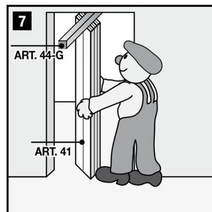
Otočte posuvnou lištu o 90° a vložte sadu dveří.
