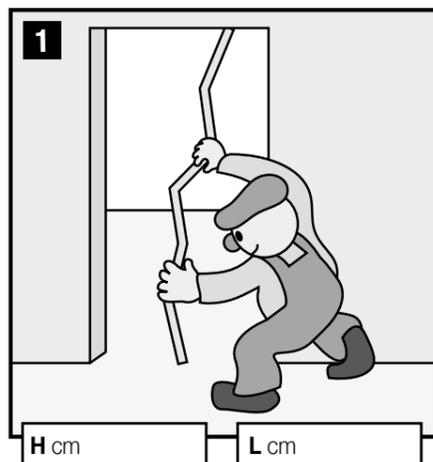
Změřte výšku H a šířku L dveřního otvoru.
