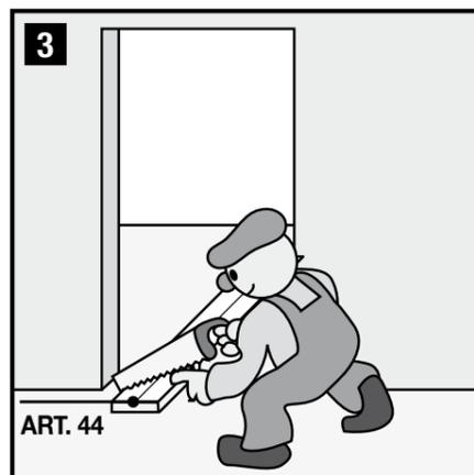
Řez posuvné lišty: L dveřní otvor
