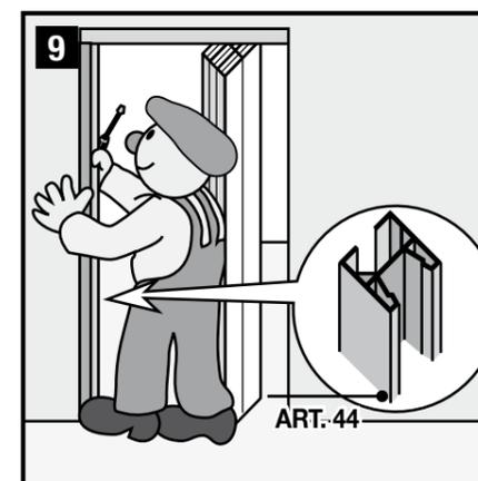
Připevněte boční spoj na začátek stranou B ke stěně.
