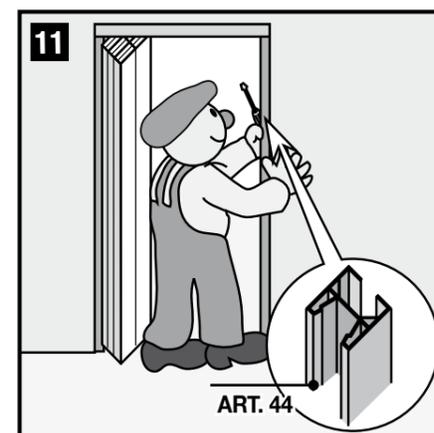
Připevněte boční připojení podle obrázku stranou B ke stěně.
