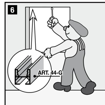
upevněte posuvnou lištu pouze středovým šroubem, stranou A ke stěně.
